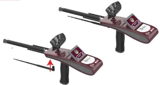
Installer l'antenne réceptrice
