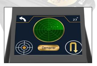
Dirigez l'appareil vers la cible tout en maintenant l'équilibre de l'appareil, appuyez sur le bouton de démarrage, attendez jusqu'à ce que vous entendiez un bip de l'appareil, puis marchez vers la cible jusqu'à ce que l'appareil tourne vers l'arrière avec l'apparition d'une icône indiquant la rotation de l'appareil vers l'arrière.
