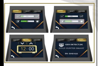
Icône des paramètres de l'appareil à travers laquelle vous pouvez définir : Niveau sonore niveau de luminosité - réglages de l'heure - informations sur l'appareil
