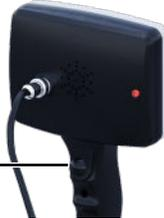
3- Soulevez et abaissez la bobine plusieurs fois jusqu'à ce que l'indicateur sur l'écran soit rempli, accompagné d'un son indiquant la fin du processus de calibration.
